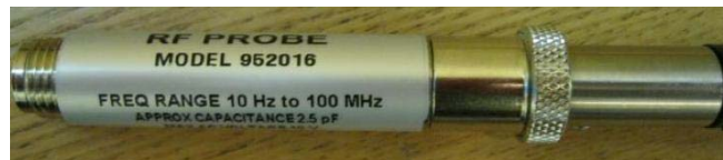
Измерительный зонд 952016 (диапазон частот от 10 Гц до 100 МГц)
