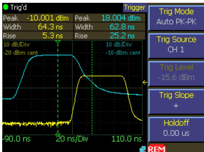
Измерители мощности 4541 и 4542 обладают широкими возможностями для обнаружения импульсов и их анализа. Такие параметры, как длительность импульса, время нарастания, время спада, распределение мощности и многие другие, обнаруживаются, измеряются и отображаются автоматически.
