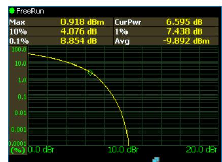
Шумоподобные сигналы подвергаются статистическому анализу. Средняя мощность, в случае представления сигналов с помощью CCDF, служит ориентиром, в то время как график показывает распределение более низких уровней мощности.
