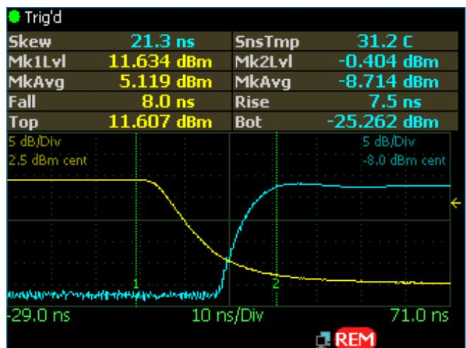
Функция «Графический заголовок» в ВЧ измерителях мощности 4541/4542 позволяет отображать до 10 выбираемых пользователем параметров. Цвета соответствуют определенному каналу: желтый – канал1, синий – канал2.
